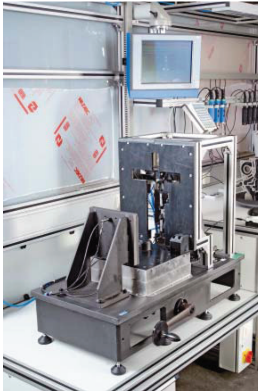
Der komplette Messplatz für Zylinderkurbelgehäuse für verschiedene Längen- und Abstandsmaße Bilder: OPW
