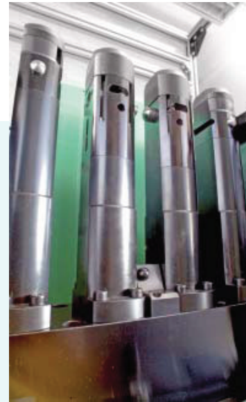
Die Anordnung der Messschlitten und Messtaster mit pneumatischer Zustellung
