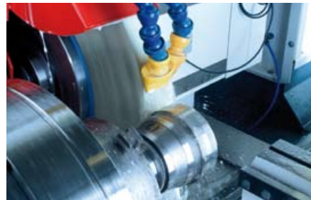
Mit der Studer S40 wird „aus dem Vollen“ geschliffen
