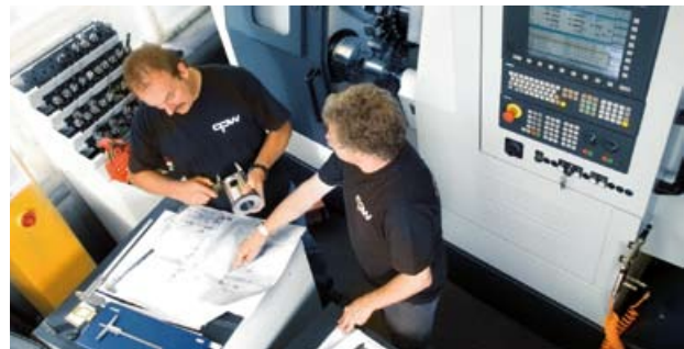
Eine Drehmaschine mit angetriebenen Werkzeugen für präzise Fertigung in einer Aufspannung
